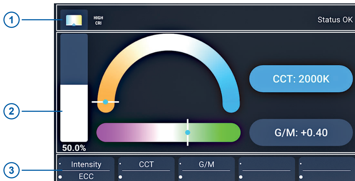
Fig. 16: Diseño de la pantalla del panel de control
