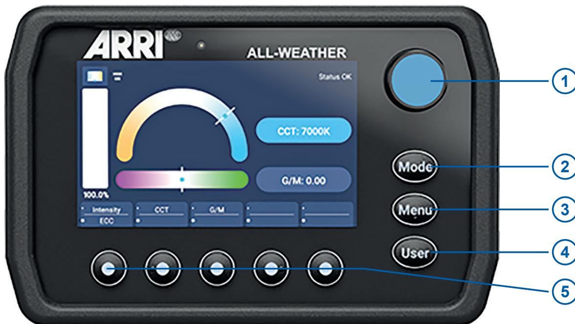
Fig. 17: Elementos de control del panel de control.
